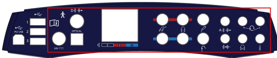
Fig. 1 Connettori con connessioni dirette ai trasduttori dei pazienti - pannello di collegamento di AURICAL Aud
